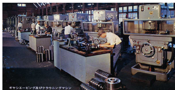
ギヤシービング及びクラウニングマシン 昭和44頃
