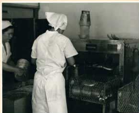
ウエット方式の旧・給食調理室 昭和34年1月完工 1人が運びもう1人が洗う アルマイトのワンプレート皿
